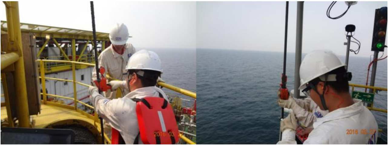
中海油海上钻井平台钢丝绳无损检测现场
